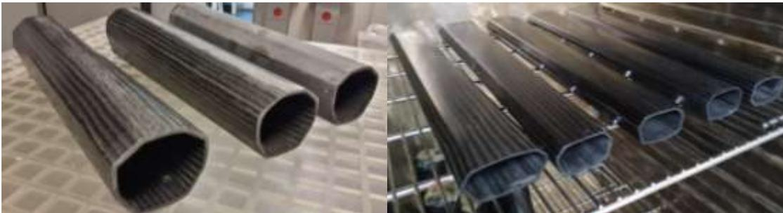
Figura 11 - Partes produzidas por HP-IRTM (tubo inferior e tubo superior).
