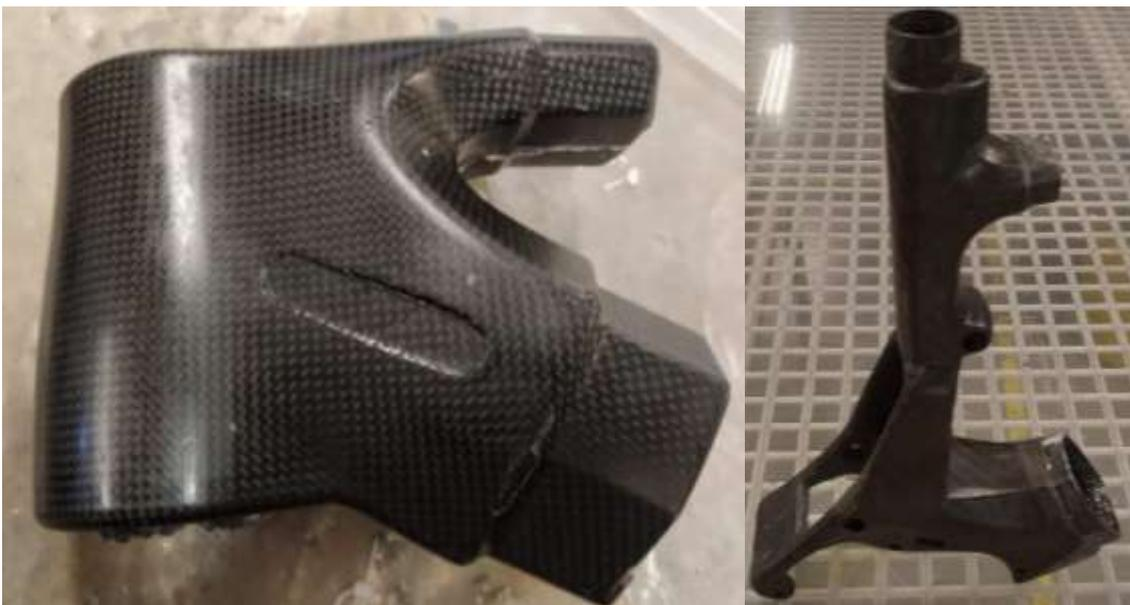
Figura 12 - Partes produzidas por Blow-Molding (tubo de direção e centro de pedaleira).
