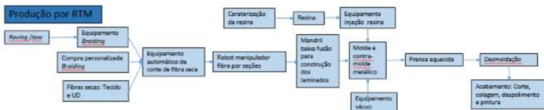
Figura 5 - Desenho esquemático do processo de produção por RTM.
